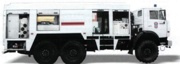
Рис. 2.48. Станция специальной обработки людей
