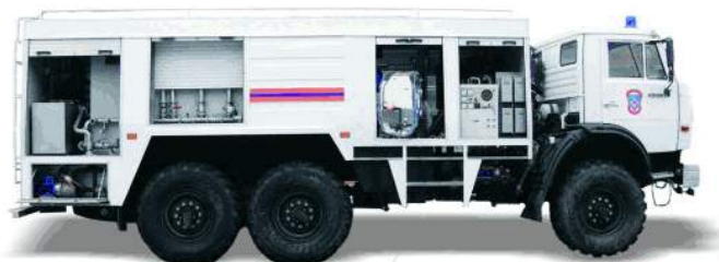
Рис. 2.47. Станция специальной обработки техники
