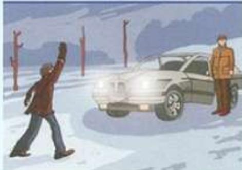
Перевозка людей на транспорте по льду КАТЕГОРИЧЕСКИ ЗАПРЕЩАЕТСЯ! При движении через переправу двери кабины автотранспорта должны быть открытыми.
